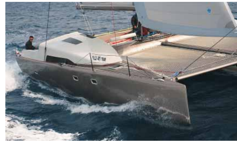
Protections. Au près dans le clapot, les étraves fines passent bien et l'équipage, protégé par les hautes hiloires, reste au sec.
